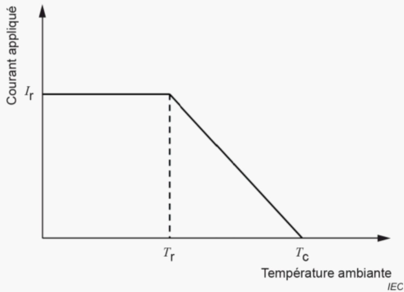
**Figure 1 – Relation entre la température ambiante et le courant appliqu\'e**
